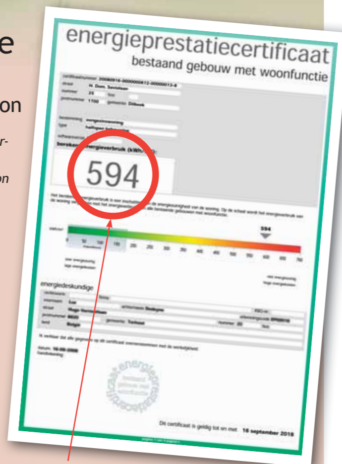
Le certificat de performance énergétique des habitations existantes ne mentionne pas le niveau E, comme pour les habitations nouvellement construites, mais précise la consommation d'énergie annuelle en kWh par m 2 .
