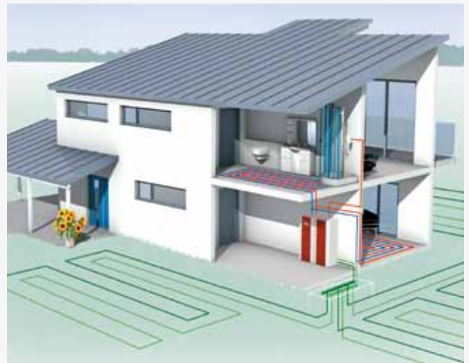
Grond/water-warmtepomp met horizontale collector
