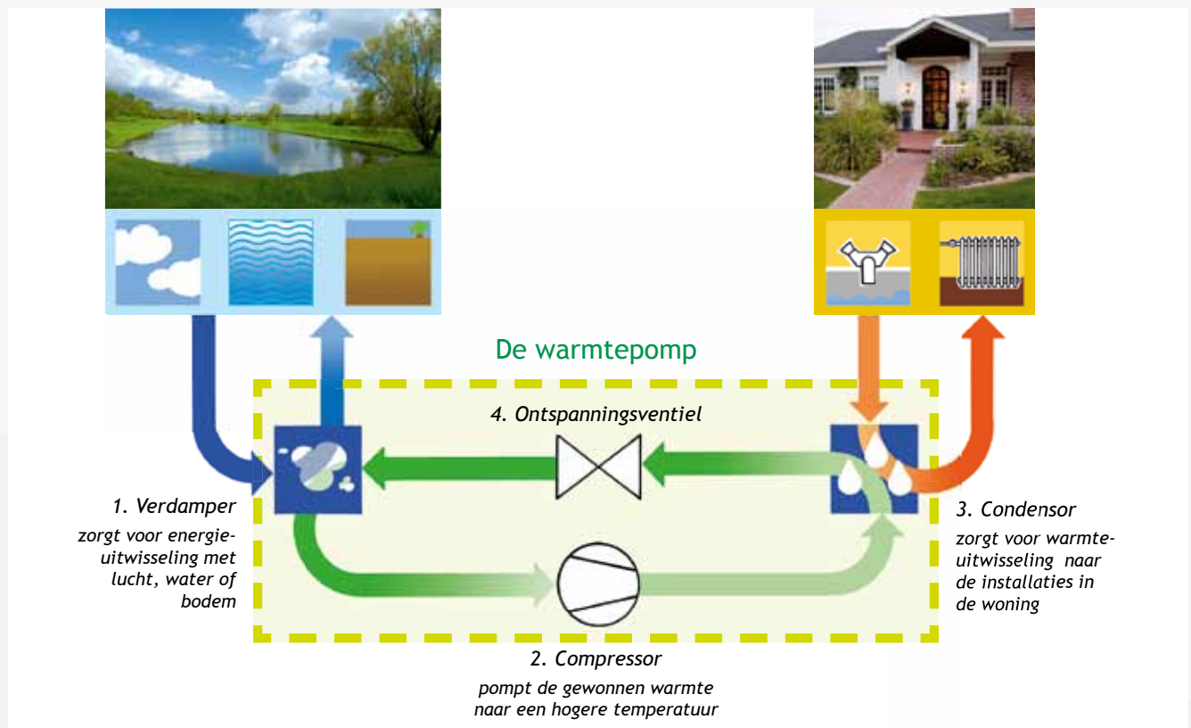
Compressietechniek van een elektrisch aangedreven warmtepomp
