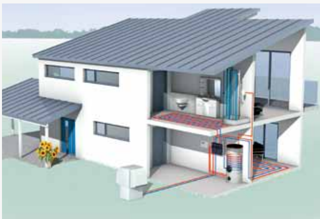
Pompe à chaleur air/eau
