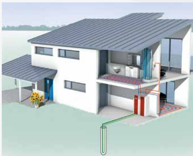
Pompe à eau sol/eau avec sonde verticale
